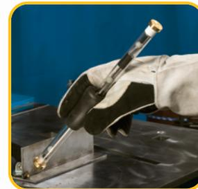
La **herramienta de calibración**, es fácil de usar y permite colocar la muestra de soldadura en cualquier posición, haciendo que el sistema conozca la ubicación exacta de la unión.
